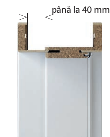
până la 40 mm pervaz special cu material mărit de reglare - produs comandat separat (cost suplimentar)
